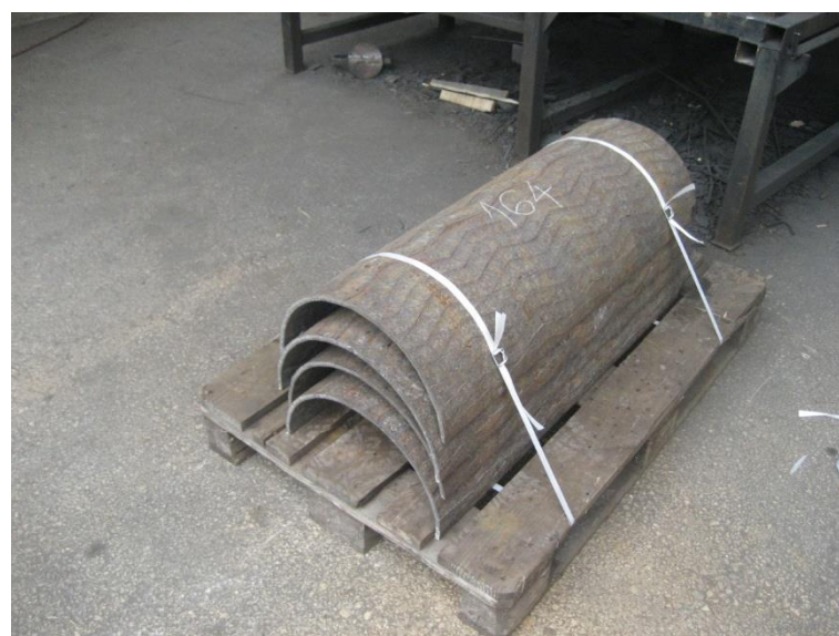
Izrada polucijevi od tvrdo navarenih ploča
