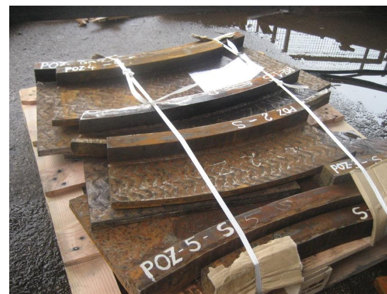
Izrada obložnih ploča kućišta mlina
